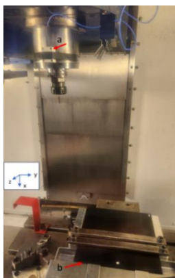
Fig. 2. Configuração de usinagem de fresamento: a) acelerômetro triaxial e b) Laminado FML.
