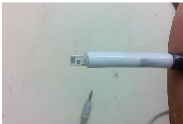
Fig. 1 – Esquema de um protótipo de um eletrodo com conexão de cabos e trilhas
