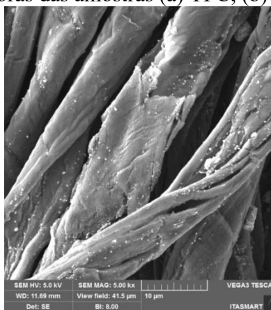
Fig. 4 - Micrografia das fibras das amostras (a) TFC, (b) TFCA 30 e (c) TFCA 1H.
