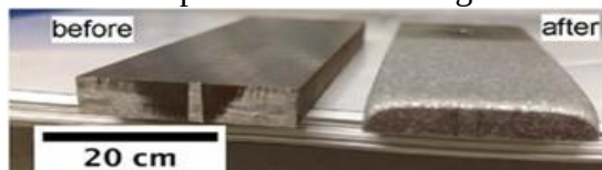
Fig. 1 - Amostras antes e depois do ensaio de desgaste abrasão-impacto.
