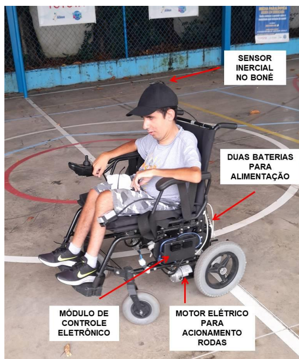
Fig. 2 – Componentes principais do sistema de controle e acionamento da cadeira para tetraplegia.
