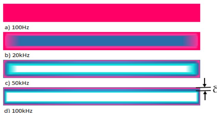
Fig. 2 – Efeito pelicular para frequências de 100 Hz à 100 kHz.
