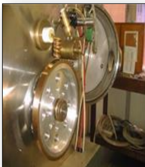
Fig. 3 - a) Foto do Melt-spinning e b) Imagem apresentando a formação da fita
