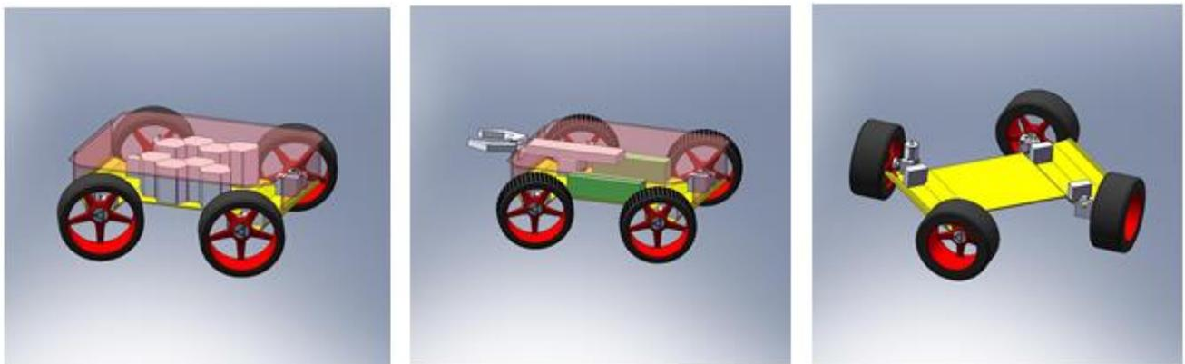
**Figura 9 -** Modelos iniciais do RoboDeck apresentando a questão do posicionamento das baterias, da pinça mecânica e da capacidade de girar sobre o próprio centro
