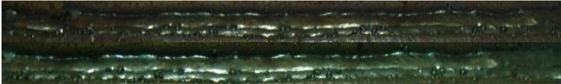
**Figura 5** - Solda não conforme.
