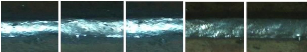
**Figura 7** - Imagens de cordões de solda conformes
