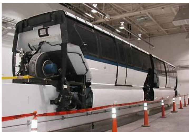
Figura 1: “Composição do monotrilho de Las Vegas sendo construído com detalhe para o sistema de tração abraçando a viga de circulação.” Fonte: Bombardier Transportation apud OLIVEIRA: 2009 p 6.
